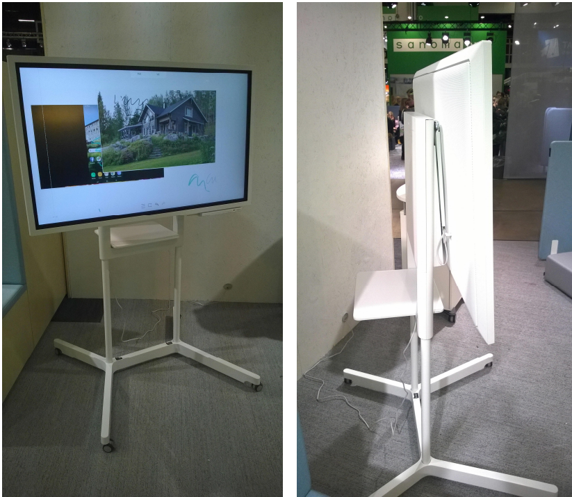
Kuva 7 Esimerkki kevytrakenteisesta siirrettävästä näyttökäytöstä, näytön koko 55", kokonaispaino n. 50 kg
